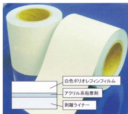
Fig. 2 ダイハート R-2000ED/EKの構成
