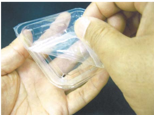
Fig.1 ディファレン E7800PETを用いた包装体を開封している様子
