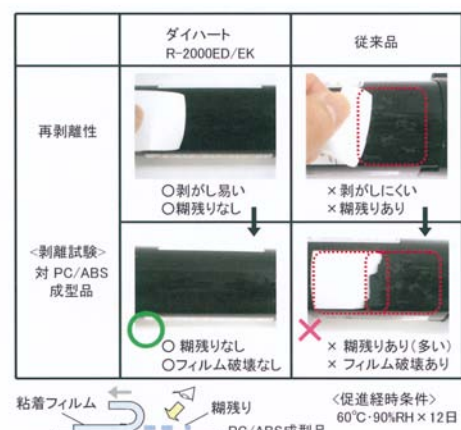
Fig.5 ダイハート R-2000ED/EK 促進経時後の再剥離性 (60・90%RH×12日後)
