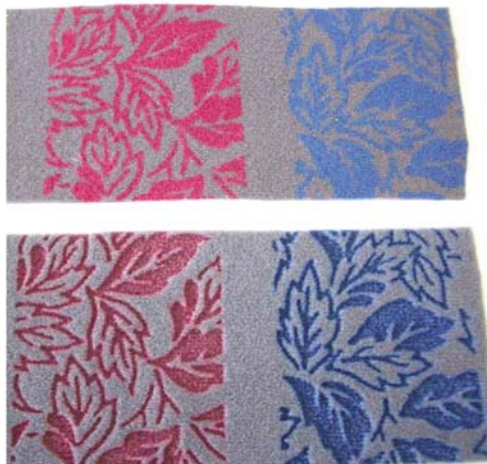
Fig. 1 着色エッチング加工見本 （上）プリント（下）着色エッチング
