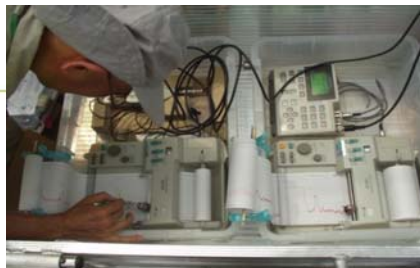
(写真7. 騒音振動測定1)
