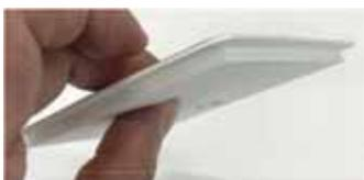
スイッチの場所の裏側も押さえながら、ハットトッテを指で挟むような形で、表側からスイッチを3秒ほど押してください。
