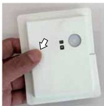
センサー開口部の位置付近の高さの左端に近いところに、電源スイッチがあります。矢印のあたりを軽く押さえながら指を動かすと、押下スイッチのボタンの凹凸があるのが分かります。
