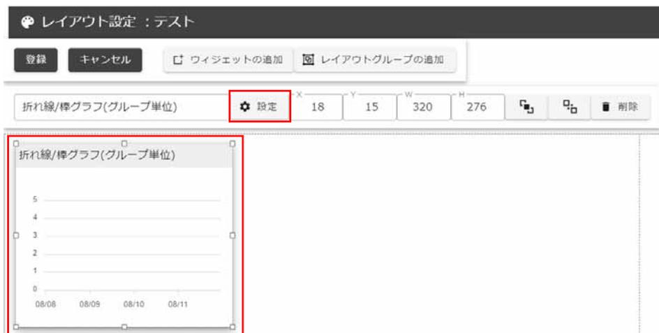
例えば、折れ線/棒グラフウィジェットであれば、設定アイコンをクリックすると開く設定用ウィンドウで、温度を表示するのか、湿度を表示するのかといった設定を行います。
