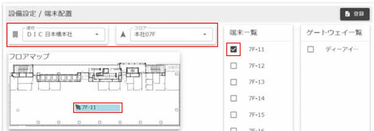
「端末一覧」には、グループに登録されている端末が表示されています。配置したい端末にチェックを入れると、フロア画面上に端末名の矢印が出現します。この矢印をマウスでドラックして、実際に端末を配置した場所に移動します。
