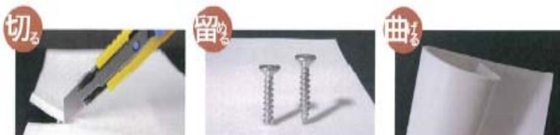
料の漏出を抑えた「蓄熱シート」の開発に成功しました。これによりラミネートパッケージ化した潜熱蓄熱材と同様の性能を有しながら、施工現場での切断や曲げ、ネジ止めなどが可能となるため、施工作業性が大幅に改善します。また、石膏ボードや床材といった一般建材とあらかじめ組み合わせることも容易になることで住宅・建築へ組み込む手段を広げ、従来難しかった壁や天井への施工も可能になります。
