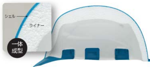
インモールド工法による帽体断面
