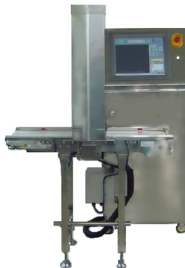
開発色素を含有させた樹脂製の擬似異物 近赤外線異物検出装置（三井金属計測機工社製）
