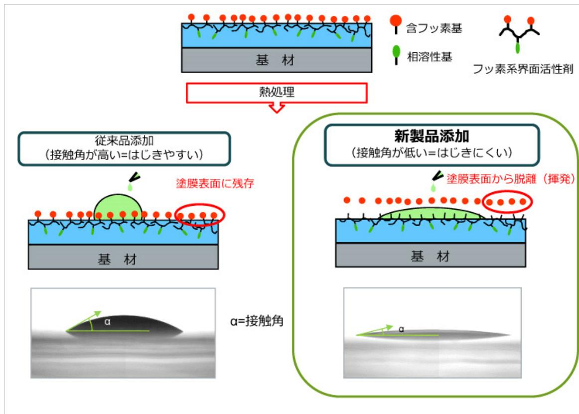
当社では、同シリーズの耐熱温度の低い材料を基板としたフレキシブルディスプレイ用途などへの展開も視野に入れ、フッ素含有基の分解温度を低下させるなどの研究開発を進めており、現在では、150℃で分解する試作品開発のめどが立ちつつあります。
