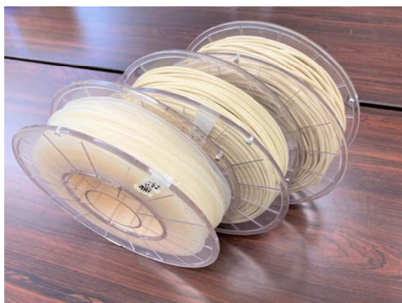
抗ウイルス・抗菌機能を有した3Dプリンタ向け 熱可塑性プラスチック材料（フィラメント）
