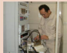
燃料電池の運転試験
