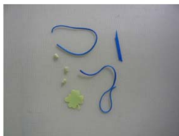
当社が開発した色素を含有させた樹脂製の擬似異物 近赤外線異物検出装置（三井金属計測機工社製）
