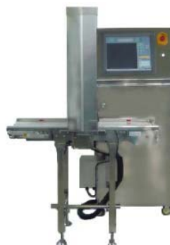
当社が開発した色素を含有させた樹脂製の擬似異物 近赤外線異物検出装置（三井金属計測機工社製）
